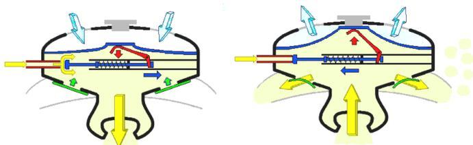
Lorsque l'on inspire il se crée une dépression dans la chambre et la membrane va pousser sur le levier qui ouvre l'arrivée d'air, à l'expiration la membrane à repris sa place et l'air expiré sort par un clapet qui se trouve derrière la moustache si le détendeur donne
