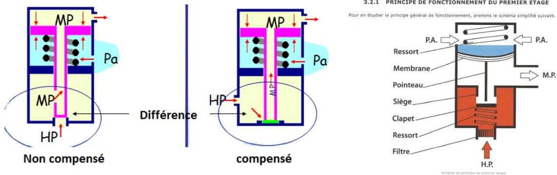
Le principe du détendeur est un rapport entre surfaces et pressions
